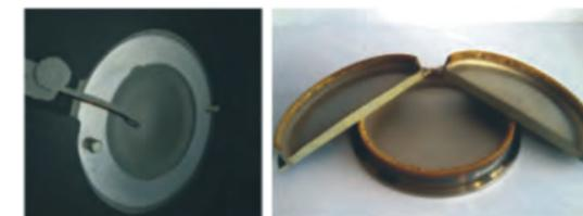
某知名进口弧源靶材蚀后的靶面 PlasArc™ 系列涂层设备靶材蚀后的靶面
